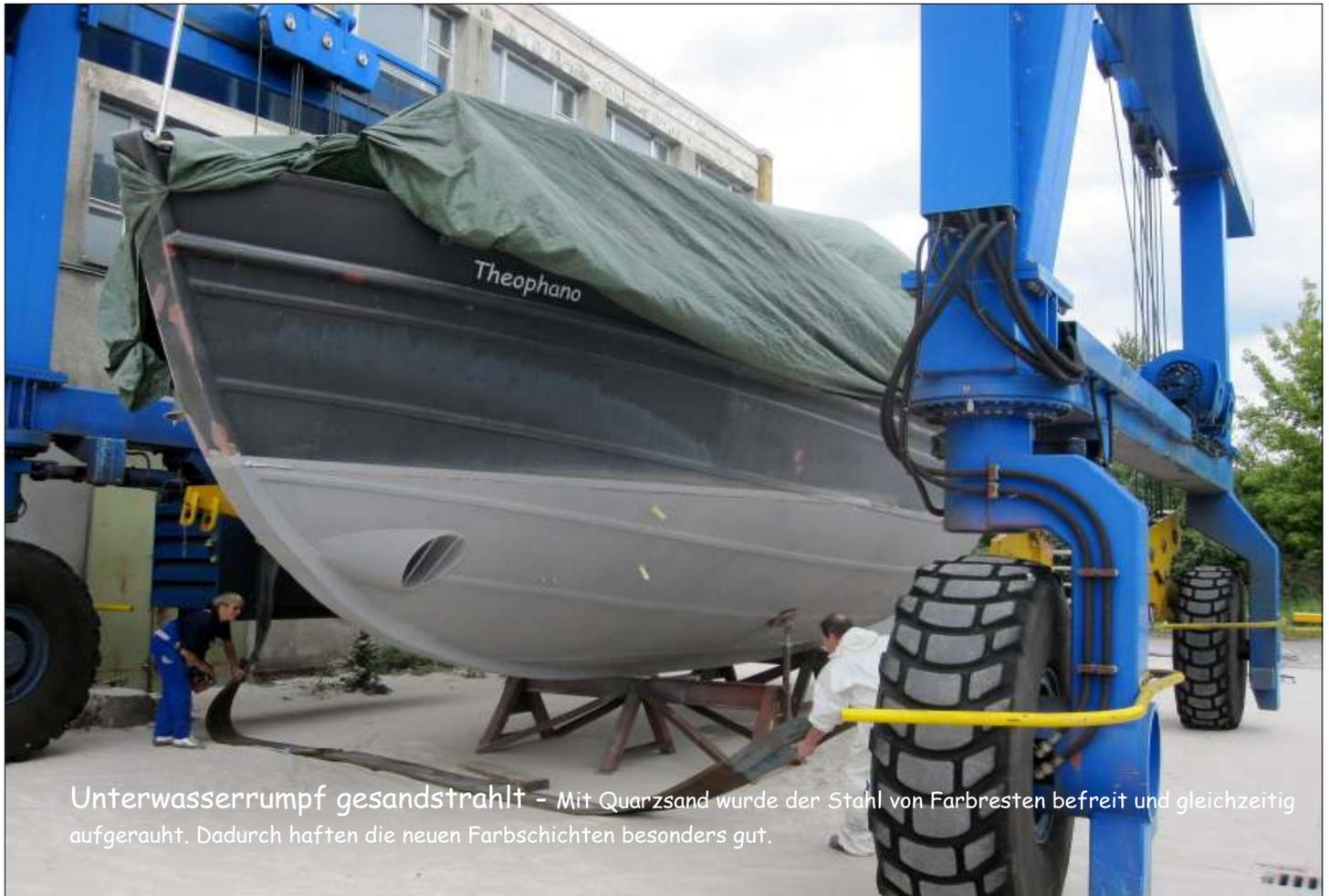
Unterwasserrumpf gesandstrahlt - Mit Quarzsand wurde der Stahl von Farbbreusten befreit und gleichzeitig aufgerauht. Dadurch haften die neuen Farbschichten besonders gut.
